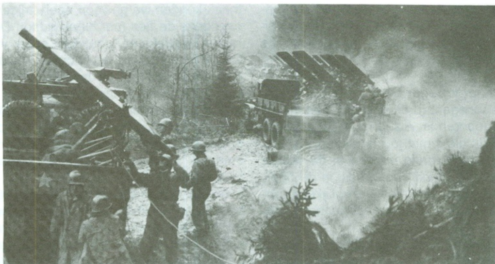
Amerikaanse troepen vuren raketten af tijdens de gevechten in het Hurtgen Wald. Twee T27 lanceerinrichtingen, elk bestaande uit een enkele rij van acht lanceerbuizen, zijn gemonteerd in de laadbak van 2 ½ ton GMC vrachtwagens. De raketten worden een halve seconde na elkaar afgevuurd.
